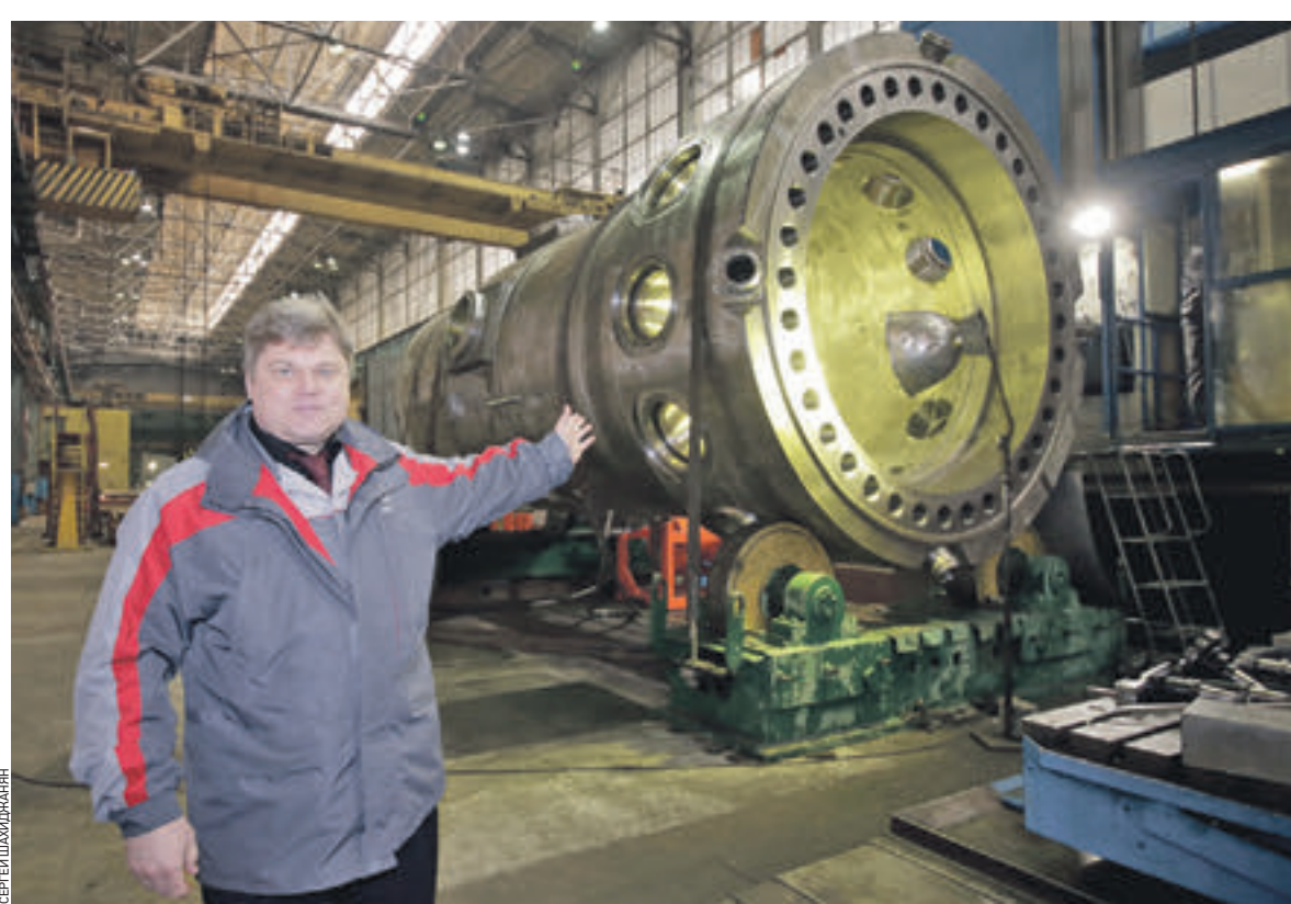
Вчера 15:33 Начальник производства реакторного оборудования Алексей Стрюков показывает на свое детище — будущее сердце атомного ледокола
