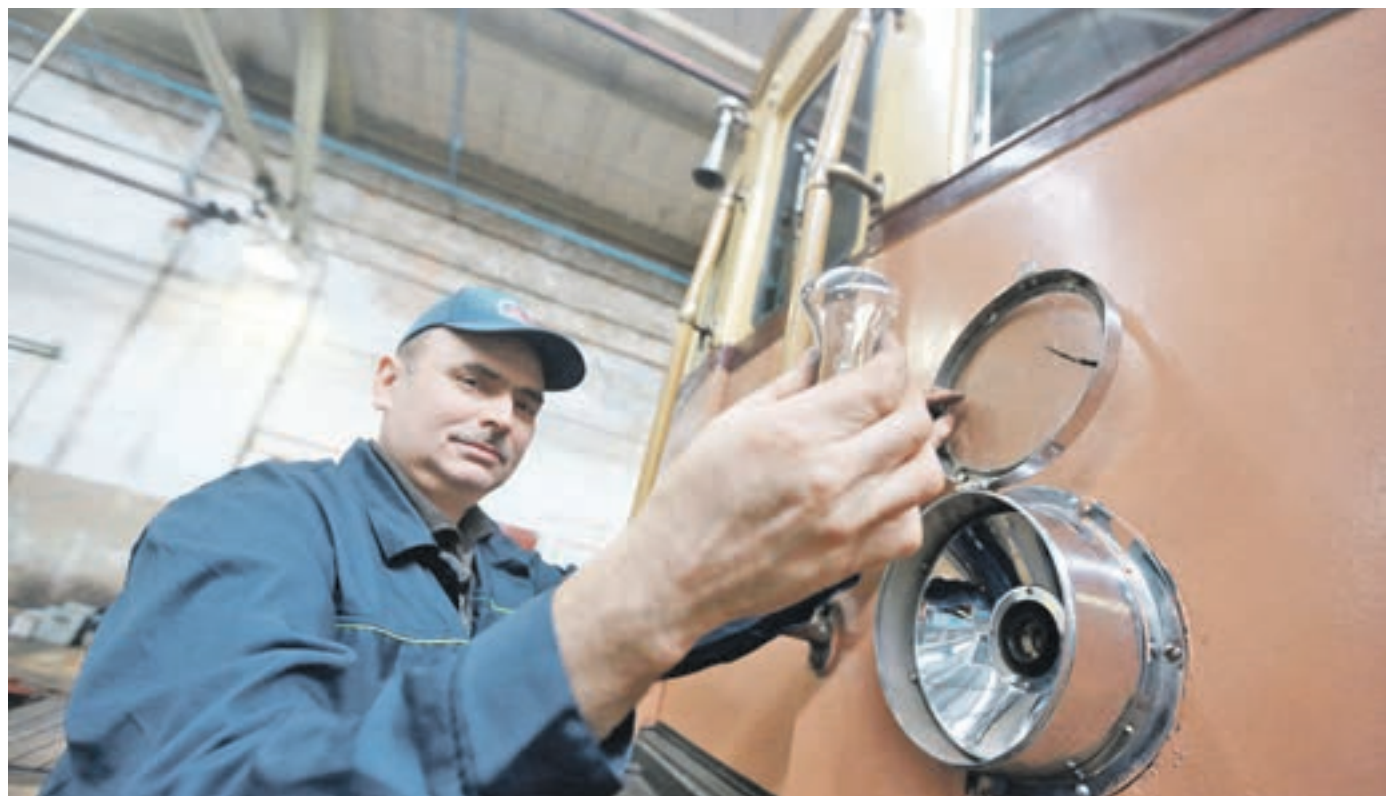
Вчера 11:38 Слесарь-электрик электродепо «Измайлово» Сергей Грибачев устанавливает новые лампы в фары ретропоезда
