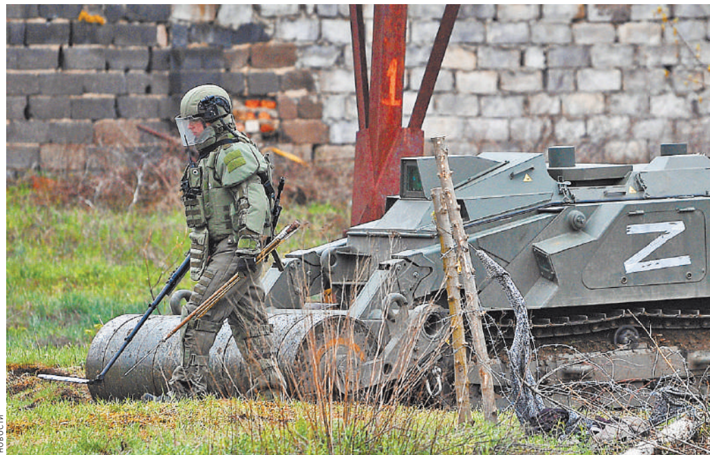
Роботизированные машины разминирования «Уран-6» могут работать самостоятельно, а могут и в паре с сапером.
