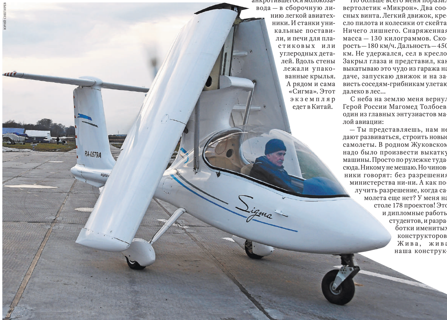
За штурвалом конструктор «Сигмы» Сергей Игнатьев. За 14 секунд самолет превращается, превращается... в автомобиль! Можно ставить в гараж.
