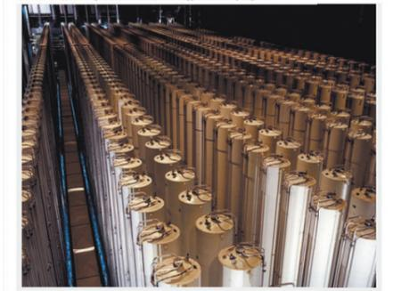
В рамках работ, проводимых Топливной компанией Росатома «ТВЗП» по производству топлива для исследовательских реакторов и реакторов на быстрых нейтронах, в ОАО «ГО «Электрохимический завод» успешно введен в работу каскад газовых центрифуг 9-го поколения для получения обогащенного уранового продукта.
