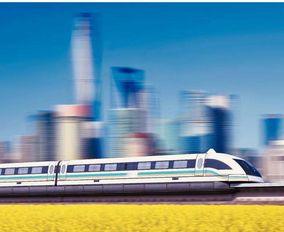
Маглев – поезд на принципе МАГнитной ЛЕВитации, без соприкосновения с рельсами – уже ходит в Китае со скоростью до 600 км/ч. Теоретически его можно разогнать быстрее самолета
