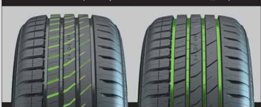
В центральной части протектора расположены перьевые канавки, направляющие поток воды от центра к внутреннему «плечу».
