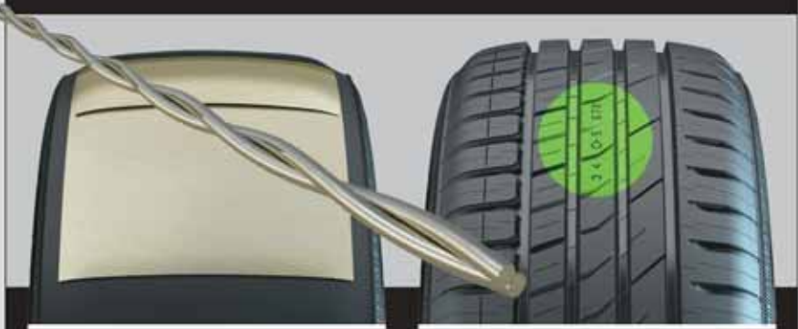
Стальной корд представляет собой сплетение стальных жил покрытых латуною.
