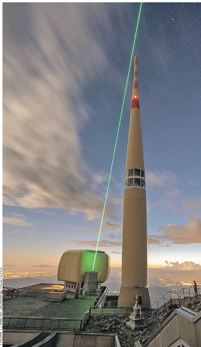
Так выглядит лазерный громоотвод, установленный на вершине горы Сантис в Швейцарии.
