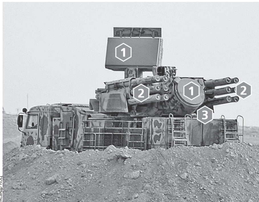
Спецкору «Комсомолки» удалось заснять комплекс «Панцирь» на боевом дежурстве под Дамаском. Его козырь - двойной радар 1 и поражение целей не только ракетами 2, но и автоматической спаренной пушкой 3 с бронебойно-зажигательными снарядами (в нерабочем состоянии не видна).
