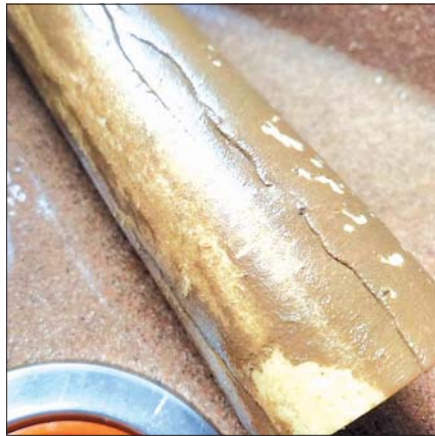
Водяные фильтры грубой очистки забиваются за неделю эксплуатации.
