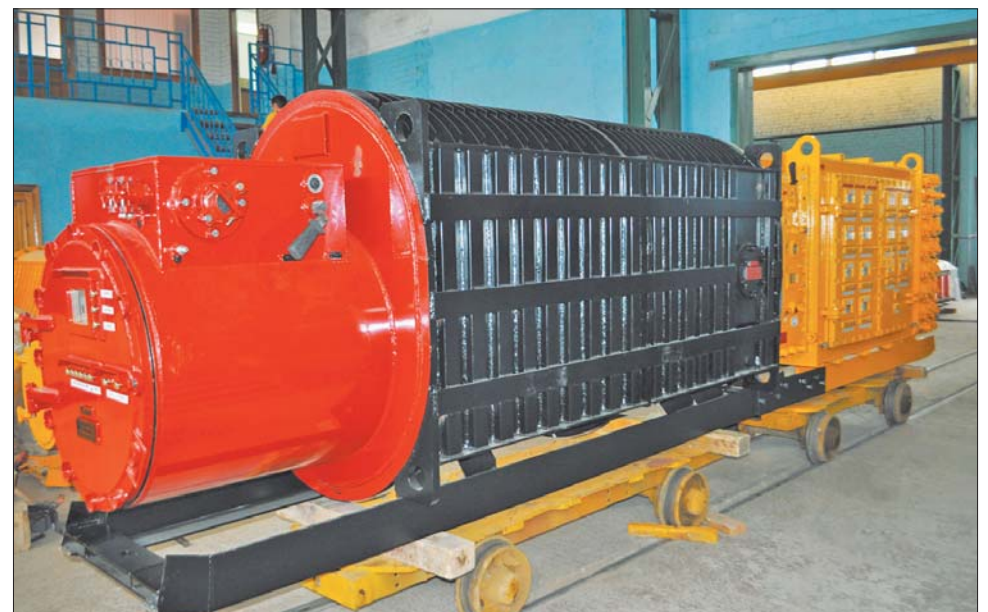
Энергопоезд КТПВШЭ-1250 изготовлен на шахтинском заводе.
