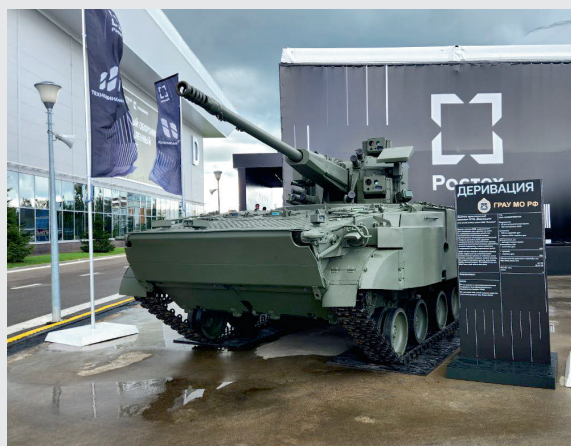
Высокоавтоматизированная 57-мм самоходная зенитная установка 2С38 «Деривация-ПВО».
