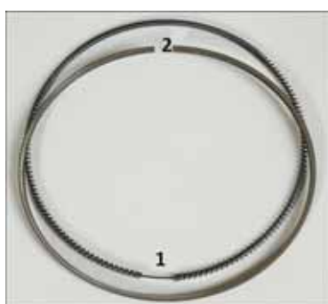
Рис. 9 Коробчатое кольцо с пружиной-расширителем
