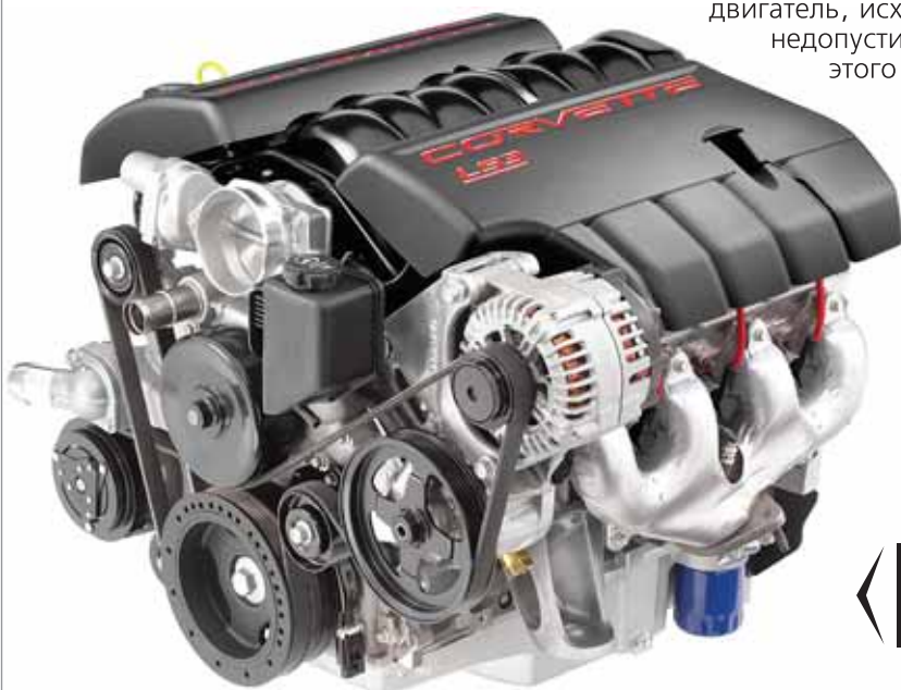
Место установки демпфера крутильных колебаний — носок коленвала. Он совмещает также и функцию шкива ременного привода
