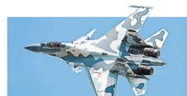
Истребитель Су-30МК (модернизированный коммерческий). Многофункциональный двухместный истребитель с передним горизонтальным оперением и двигателем с отклоняемым вектором тяги, с новой бортовой электроникой, новой РЛС и расширенным составом вооружения класса «воздух - воздух» и «воздух - поверхность». Производится в модификациях МКИ (для Индии), МКК (для Китая), МКА (для Алжира) и др.
